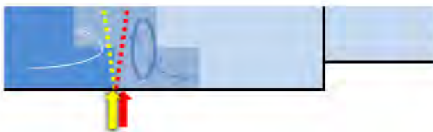
Figuur 5.2 Schets van het stroombeeld rondom een bellenscherf(aangegeven in rood) ondersteund door waterscherf (aangegeven in geel)
