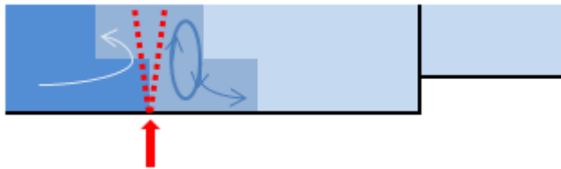
Figuur 5.1 Schets van het stroombeeld rondom een bellenscherf met zout water links, gemengd zout-zoet water rondom het bellenscherf en zoet water in de sluiskolk waar langzaam gemengd zout-zoet water vanuit de zone bij het bellenscherf instroomt
